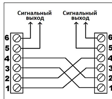
**Подключение 2:** при таком подключении можно присоединить к клеммам 1 и 3 внешнее электрическое устройство (поплавок, таймер, выключатель, и т. д.) для дистанционного включения насоса. Таким образом, двигатель включится только в том случае, если внешний контакт между клеммами 1 и 3 будет замкнут. Клеммы 5 и 6 предназначены для релейного выхода, используемого для сигнала тревоги. Клеммы 2 и 4 должны соединяться перемычкой.
