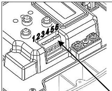
Устройство BRIO-TOP оснащено клеммной панелью, при помощи которой становятся доступны вспомогательные контакты, позволяющие производить соединения BRIO-TOP с другими внешними приборами;
