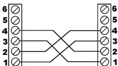
Соединение между устройствами Brio Top может быть выполнено при помощи экранированного кабеля  $4 \times 0,5 \text{ мм}^2$ , как показано на схеме рядом. Максимальная длина кабеля составляет 100 см, включая оголенные части.
